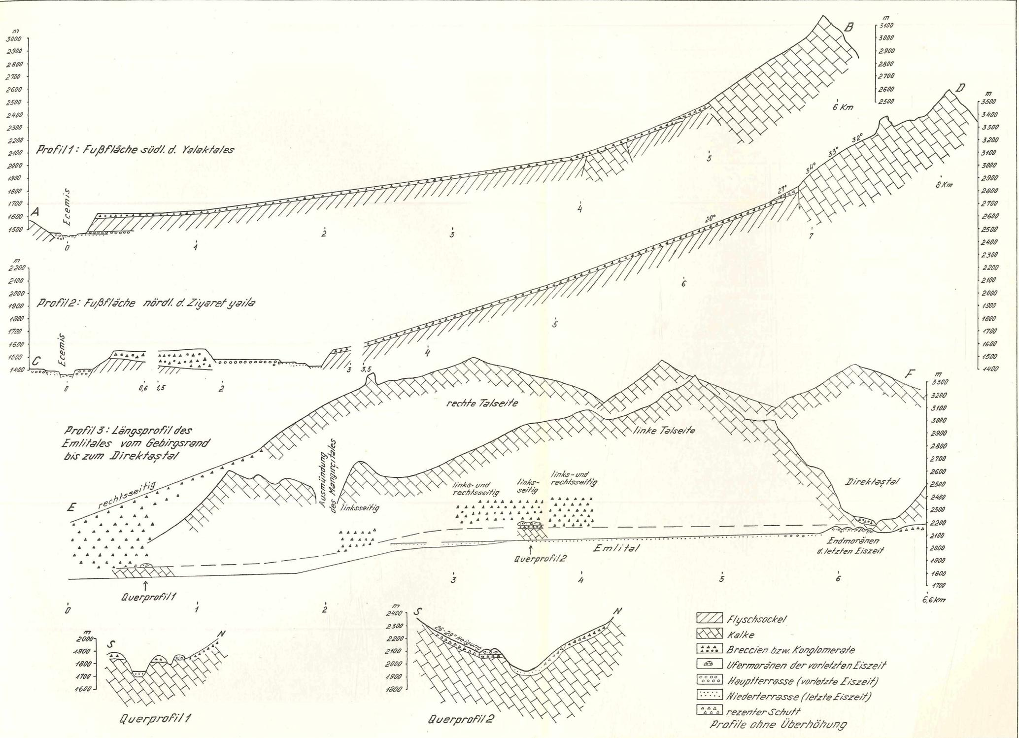
Zu Querprofil 2: Der Hang mit 26—29° Neigung ist von mächtiger alter Breccie (nicht von rezemem Schutt) eingenommen; die Breccie entspricht den Konglomeraten unter der Ufermoräne sowie auch der Breccie des gegenüberliegenden Hanges.
