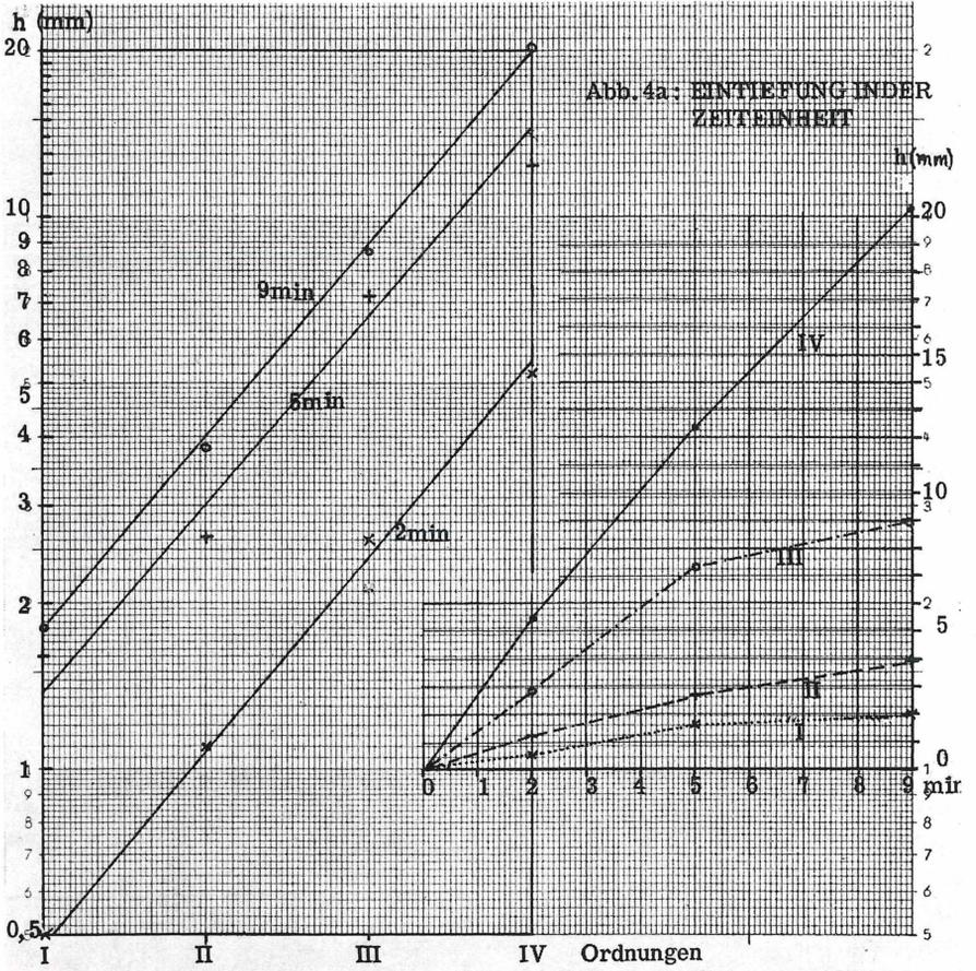
Abbildung 4: Eintiefungsverhältnis von Rinnensystemen im Laborversuch. Hangneigung  $30^\circ$
