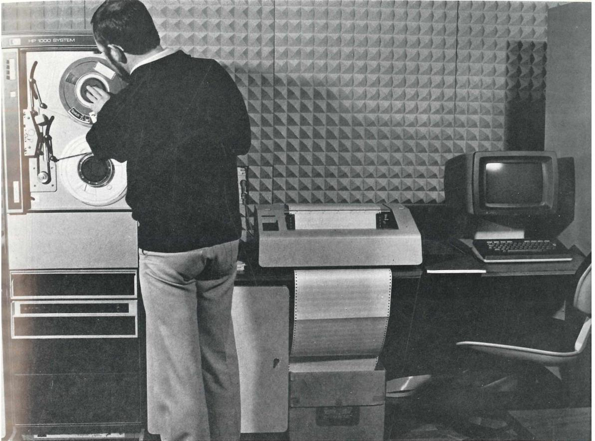
Satellitenbildauswerterraum. Von links nach rechts: Magnetbandstation und Plattenlaufwerk, Rechner, Drucker mit Papiernachschub, Terminal 1
