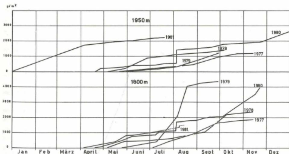
Abbildung 6: Summierte Werte des Bodenabtrags mit Entnahmezeiten an den Testflächen 1800 m und 1950 m
