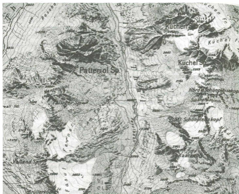
Abb. 1: Karte der Ferwallgruppe 1 : 50 000 (Ausschnitt) 1899. Bearbeitung: F. BECKER und L. AEGERTER, Originalkarte in fünf Farben (Beilage zur Zeitschrift des Deutschen und Österreichischen Alpenvereins 1899). Früher, gelungener Versuch von der schematischen Felsdarstellung abzugehen, Felsgelände ohne Höhenlinien
