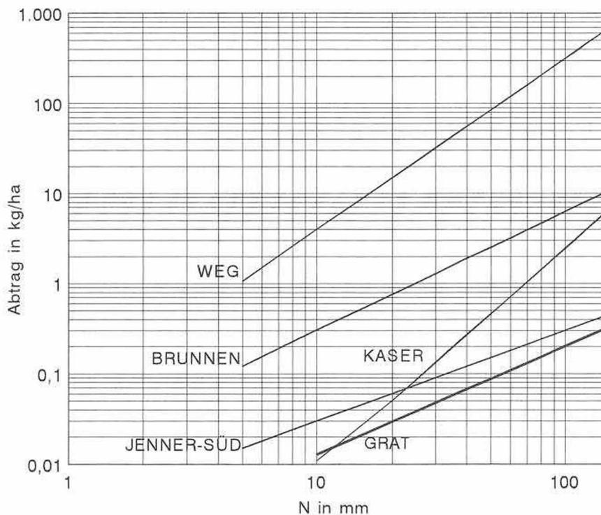
Abb. 4: Der Parzellenabtrag als Funktion der Niederschlagshöhe
