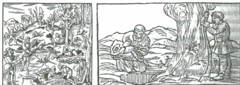
Abb. 1: Links: Früheste Formen der Eisenerzgewinnung (AGRICOLA 1557). Rechts: Bildliche Darstellung der Grubenverkohlung (BIRINGUCCIO 1559)
