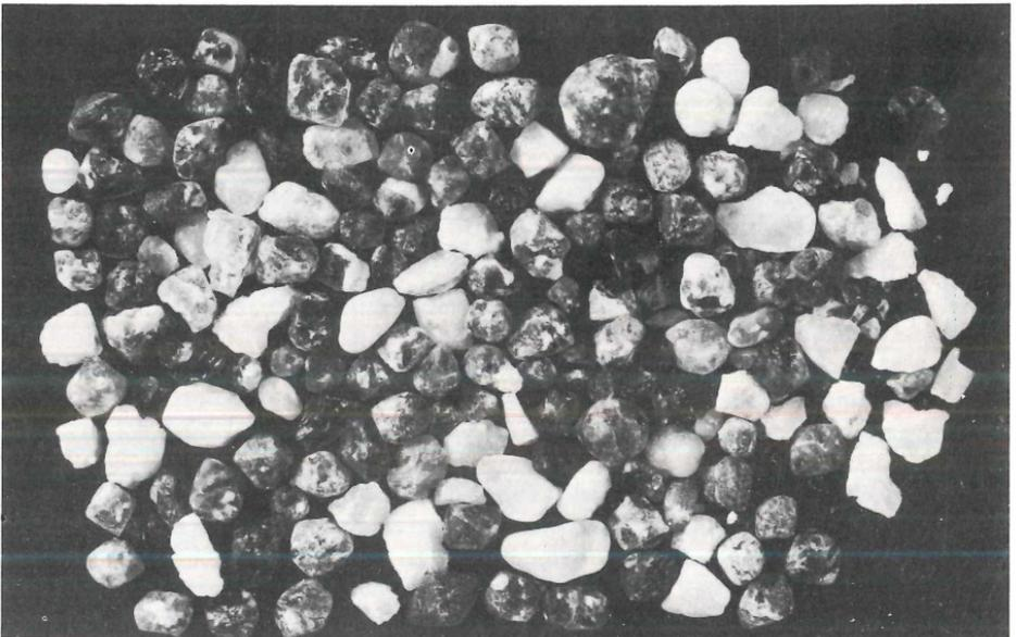
Abb. 49: Probe W 1 Q, Grube Wöllstein. Die nicht verfärbten, niedrig thermalen Gangquarze bilden einen beträchtlichen Anteil in der Korngrößenfraktion 0,5 – 2 mm. Bildbreite 3,5 cm.
