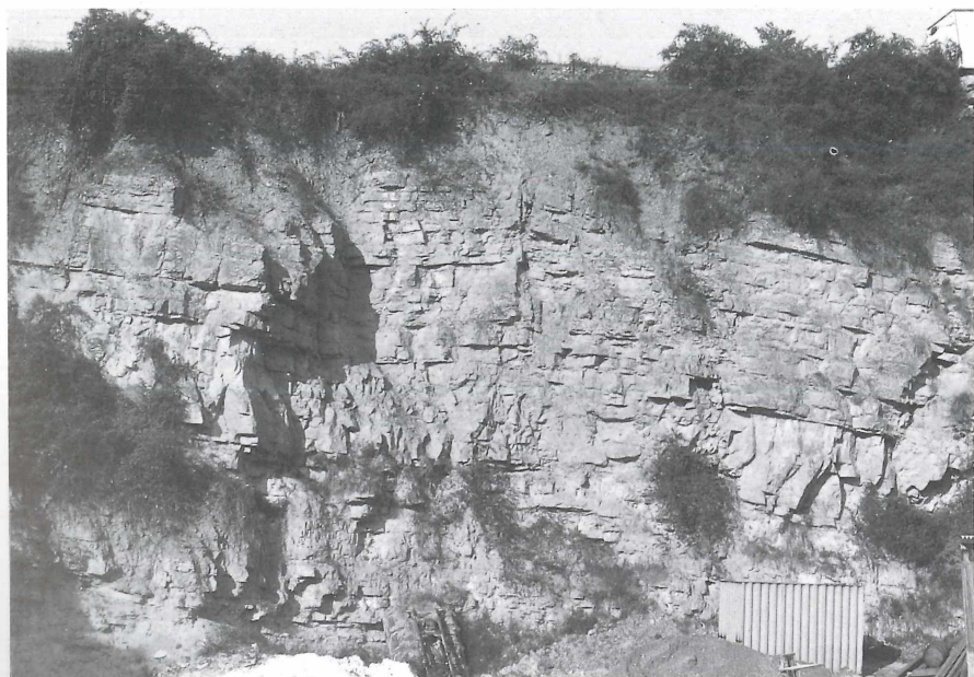
Abb. 8: Unterer Steinbruch der Firma Semar (r: 34 27 280, h: 54 43 650, Blickrichtung N). Über der Steinbruchsohle folgt in ca. 4 m Höhe die Grenze mm/mo, welche durch den Bewuchs mit Pflanzen verdeutlicht wird. Darüber folgen z. T. massige Kalkbänke des tiefen Trochitenkalkes. Bemerkenswert ist die Versteilung des Einfallswinkels innerhalb des Steinbruches.
