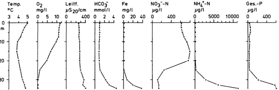
Abb. 2: Abhängigkeit einiger physikalischer und chemischer Parameter von der Tiefe im Ulmener Maar am 26.03.1982
