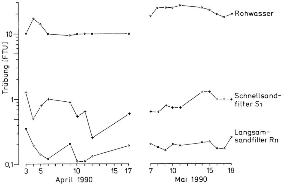
Abb. 5: Eliminierung der Trübung durch die NEA
