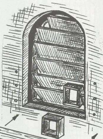
Eine von vielen Möglichkeiten : Nistkästen sind direkt hinter die geschaffene Öffnung im Schalladen anzuschrauben. Ein Holzrahmen wird in die ausgesägten Lamellen geschraubt und stabilisiert diese wieder. Ist der Schalladen zu schmal, wird ein weiterer Rahmen eingesetzt und der Kasten am Mauerwerk befestigt (Dübel, Schrauben).
