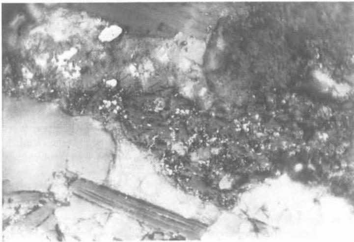
Abb. 1: Fein verteiltes  $UO_2$  (schwarze Punkte im Bindemittel) in den Serizitquarziten der Phyllit-Serie, Lenz im Kaltenegg, südöstlich von Rettenegg (Stmk.). 450fach.
