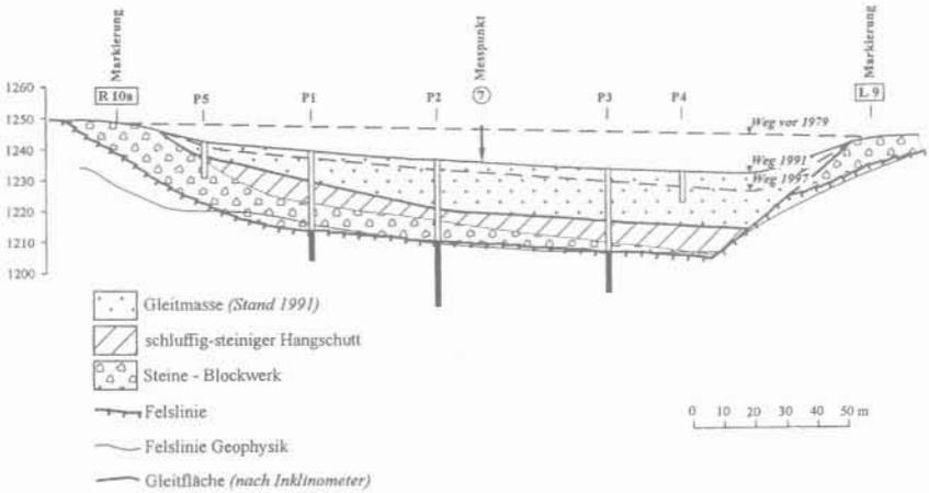
Abb. 11: Profilschnitt quer zur Rutschung entlang des mittleren Weges. Deutlich ist die Asymmetrie des Rutschkörpers in rinnenförmigem Untergrund erkennbar.
