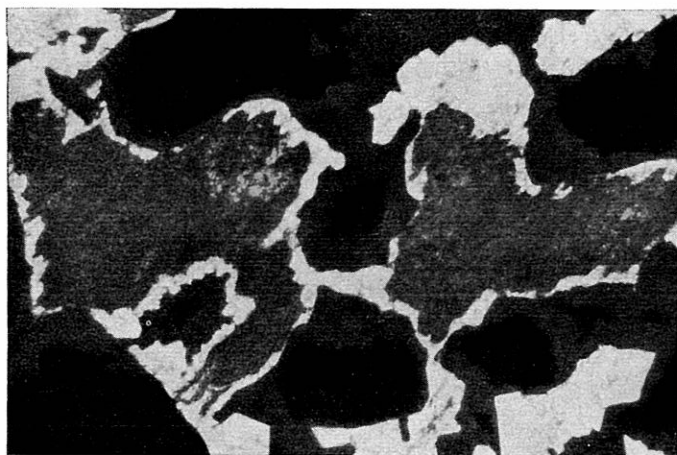
Abb. 7: In Nadeleisenerz (dunkelgrau) nach Siderit Reste von Markasit (lichtgrau; Risse teilweise entlang Korngrenzen), der ursprünglich im Eisenspat eingebettet lag und sich teilweise zumindest durch Verdrängung von Magnetkies bildete. Die Korngrenzen gegen Siderit sind, obwohl dieser von Nadeleisenerz verdrängt wurde, noch deutlich zu erkennen und Markasit wird entlang Korngrenzen nur wenig, hauptsächlich aber von innen heraus durch Nadeleisenerz verdrängt. Dadurch ist oft von den Markasitindividuen nur mehr ein äußerer Saum erhalten, der die Aggregatform abzeichnet, während der Kern fast vollständig von Nadeleisenerz verdrängt wurde, in dem sich stellenweise noch Reste von Markasit finden.
