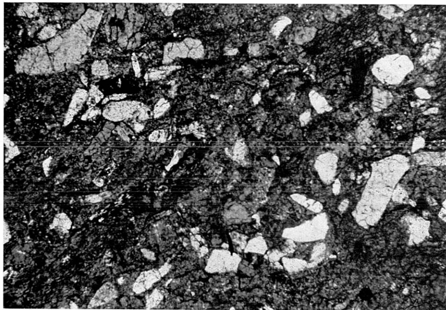
Abb. 1 Quarzporphyr vom Erzberg (Eva), Vergrößerung 35mal, teilw. \times Pol.
