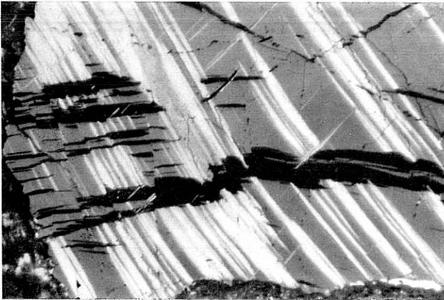
**Abb. 4:** Birkfeld, „Metagabbro“, Bahnviadukt. Ausschnitt aus einem Ilmenitkristall. Durch starke tektonische Beanspruchung ist der Ilmenit stark druckverzwilngt, wobei die einzelnen Lamellen verbogen und zerbrochen und um kleine Beträge gegeneinander versetzt sind. Ein Teil der Lamellen befindet sich in Dunkelstellung und erscheint daher schwarz. (Nicols+, Vergr. 85×)
