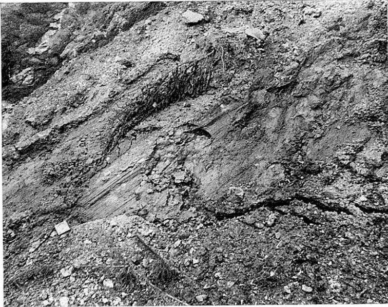
Abb. 12: Ein Detail aus dem Mylonit. Der Geologenkompaß dient als Größenvergleich. Der Harnisch trägt deutliche Rutschstriemen (1 : 195/49), die von den jüngsten Hangbewegungen herrühren. Auf der Gleitfläche sind auch deutlich die rundlichen (helleren) Gesteinsbruchstücke zu erkennen, die durch einen dunkleren, feinkörnigen Letten miteinander verkittet sind. Die dunklen waagrecht verlaufenden Risse zeigen, daß die Absenkung anhält.
