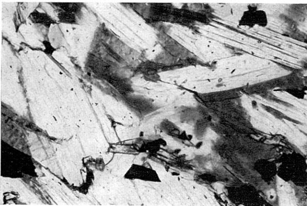
Abb. 5: Baueritierung von Biotit. Die dunklen Flecken entsprechen dem Pleochroismus des Biotit. (Schliff Nr. 1, 184fach, o. N.)
