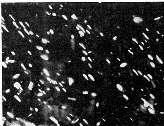
Abb. 8: Feinnadelige Einschlüsse im Feldspat, welche als Sillimanit gedeutet wurden. (Originalschliff von A. CLOSS aus der Korralpe, m. N.)
