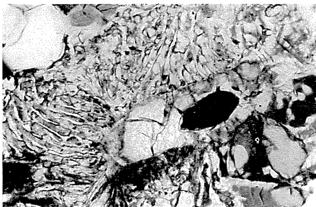
Abb. 3: Omphazitkern mit Diablastik von Hornblende-Quarz (Albit) im Übergang zu Hornblende (links oben). (Schliff Nr. 119, 184fach, n. M.)
