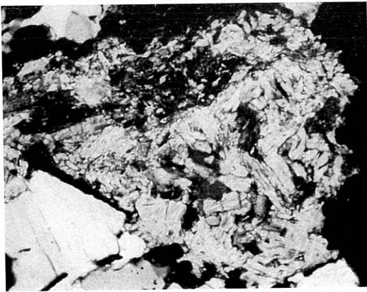
Abb. 2: Disthenhaufwerk nach Andalusit mit teilweiser scharfer Kristallbegrenzung. (Schliff Nr. 95, 100fach, m. N.)
