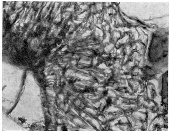
Abb. 4: Diablastik von Hornblende-Albit zwischen zwei Omphazitindividuen. (Schliff Nr. 119, 300fach, o. N.)
