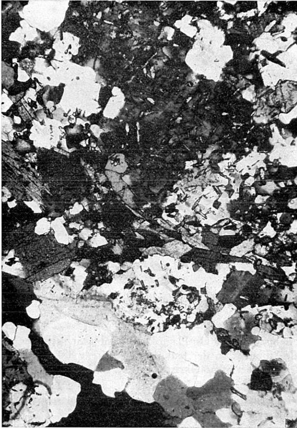
Abb. 4: Diorit-Granodiorit; korrodierter Alkalifeldspat-PorphYROBLAST mit haupts. Epidot/Klinozoisit-Einschlüssen, Schliff Nr. 11/1, (+) Nic., 30 ×.
