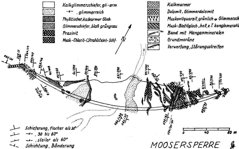
Abb. 5: Moosersperre — Oberstufe Kaprun; Geologische Skizze der Gründungsfläche (G. Horninger)
