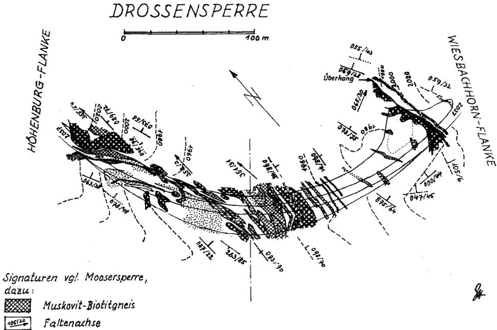
Abb. 6: Drossensperre — Oberstufe Kaprun; Geologische Skizze der Gründungsfläche (G. Horninger)
