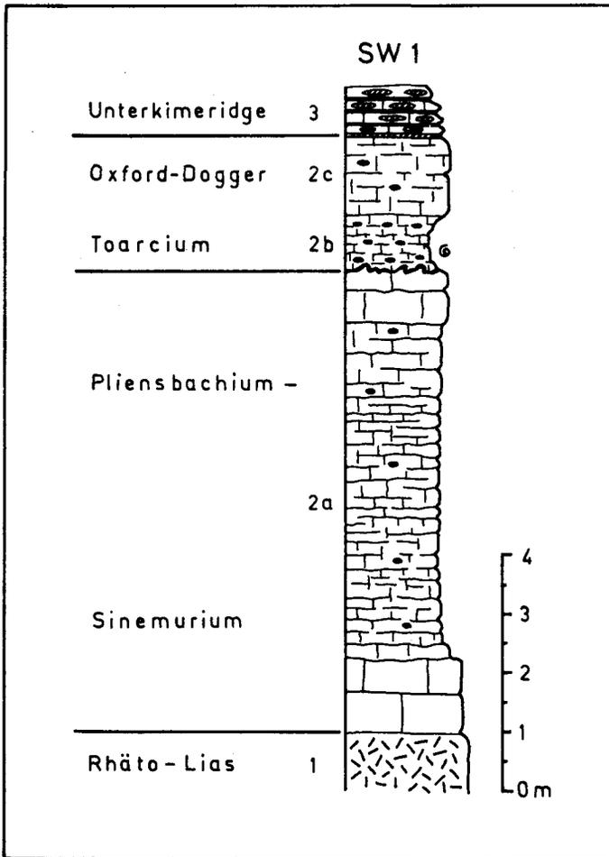
Abb. 7: Profil durch den roten Jurakalk des Sonnwendgebirges (bei der Dalfazer Alm), Tirol. 1 Weißer Riffkalk des Rhäto-Lias, 2a—c Roter Jurakalk verschiedener Ausbildung, Emersionshorizont an der Basis des Toarcium, 3 Radiolarit des Unterkimeridge, basal Mylonitzone (Ausschnitt aus den Profilen bei W e n d t, 1969a).
