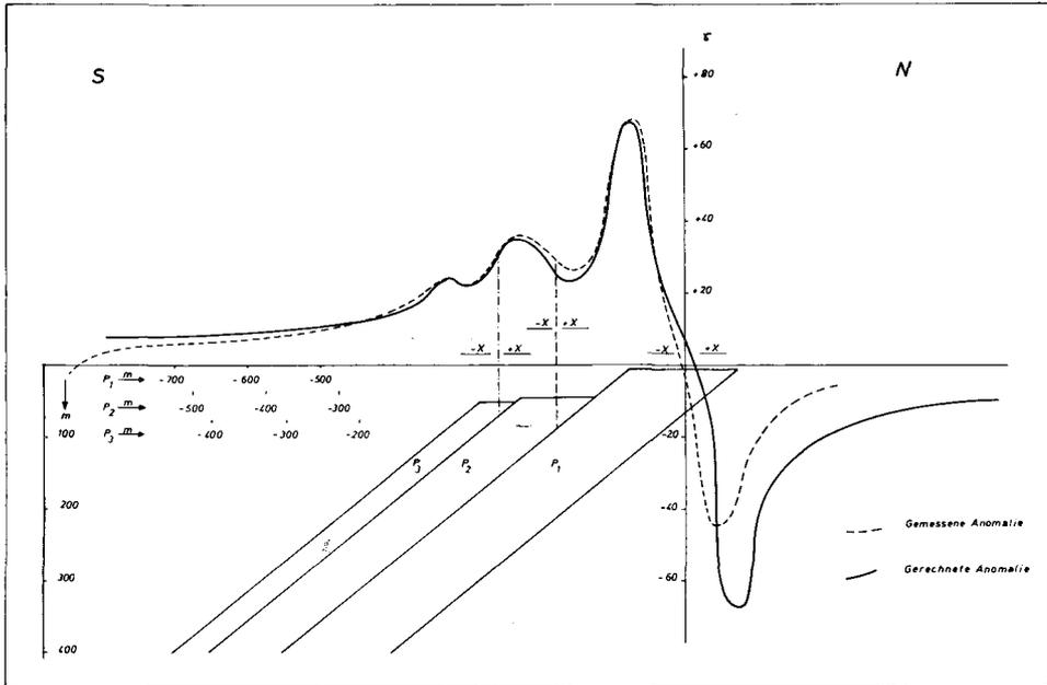
Abb. 7: Störkörperberechnung der Anomalien von Rattenberg
