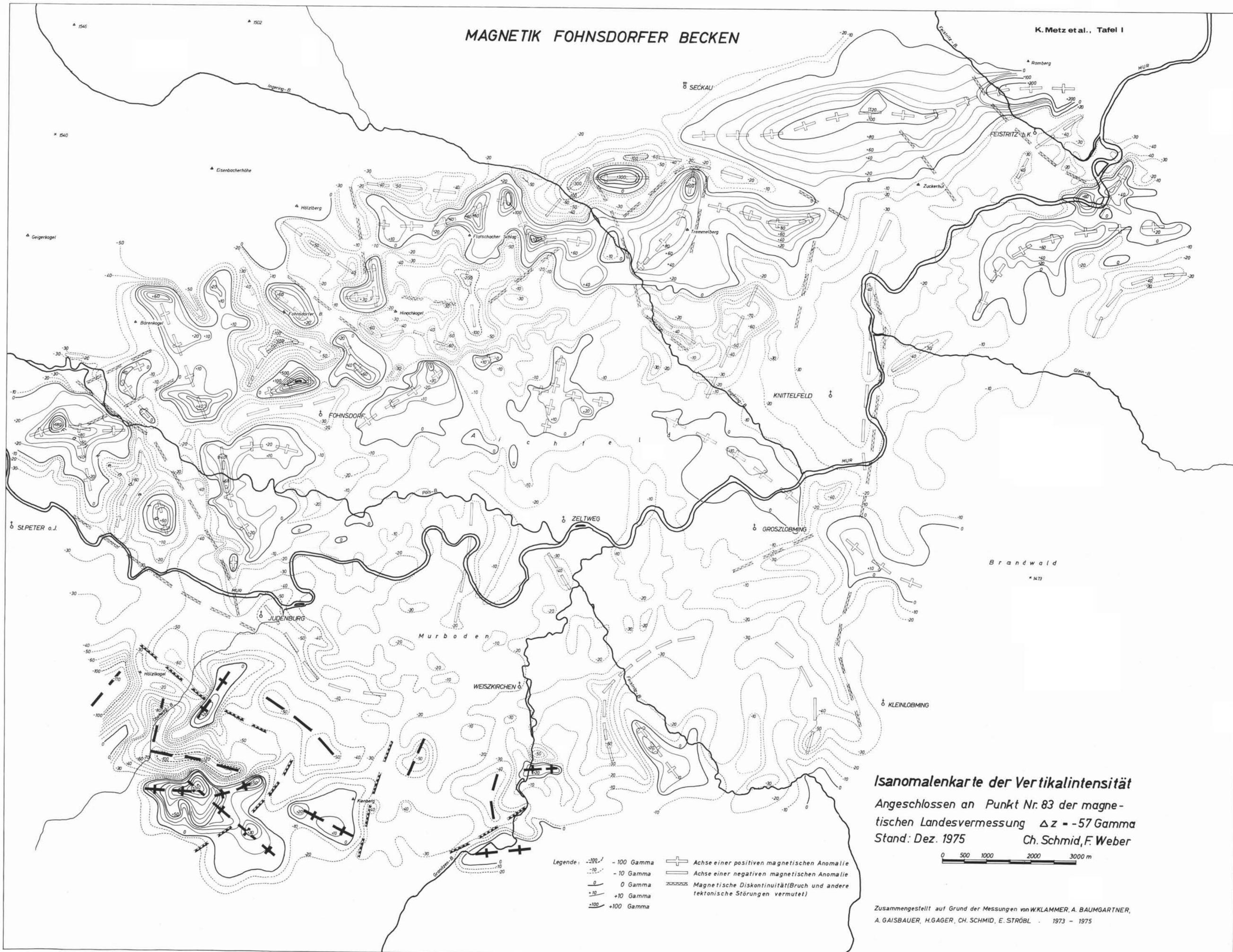
**Isanomalenkarte der Vertikalintensität**
