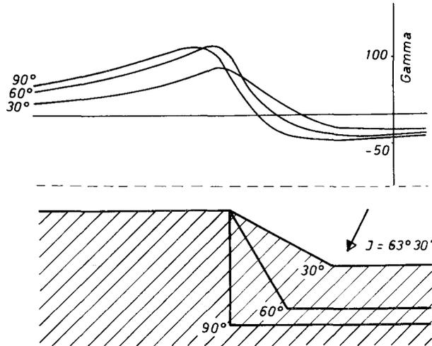
Abb. 3: Anomalie einer Platte in verschiedener Tiefe
