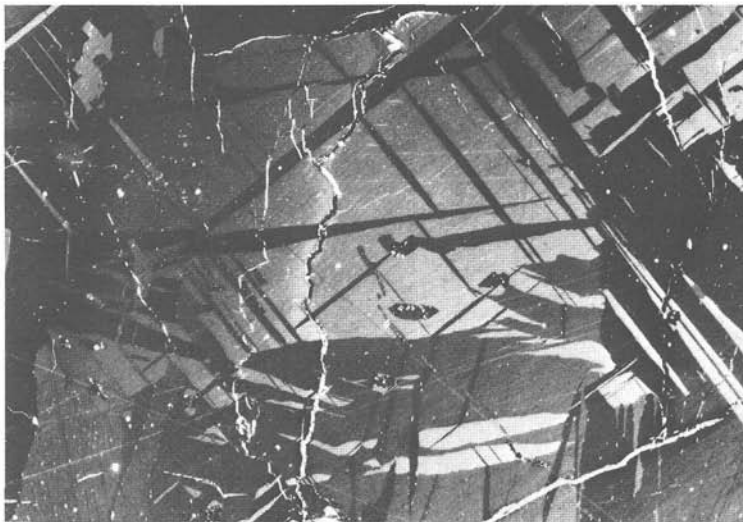
Abb. 21: Meiselding (Kärnten). Kupferkies weist charakteristische oleanderblatt- bis lanzettförmige Umwandlungslamellen der Hochtemperaturform auf. Anschliff, Vergr.: 75 \times , Polarisatoren +
