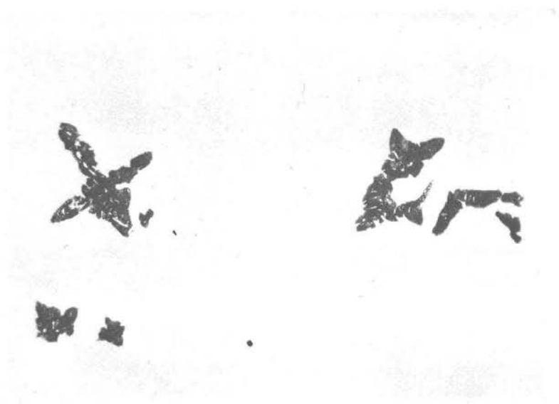
Abb. 20: Meiselding (Kärnten). Kupferkies (Hochtemperatur-Kupferkies; fast weiß) mit Entmischung von Zinkblende (dunkelgrau) in Form der typischen, deutlich verzweigten „Zinkblende-Sternchen“. Anschliff, Ölimmersion, Vergr.: 375×.
