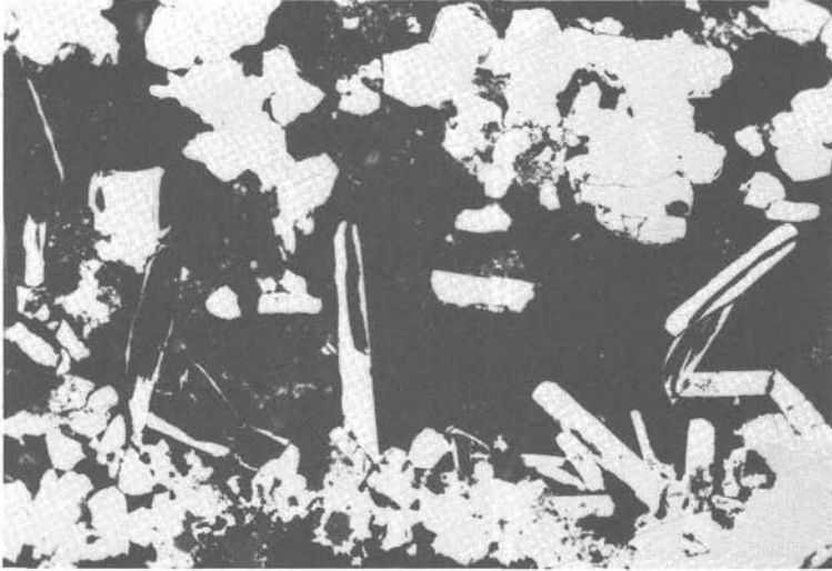
Abb. 31: Probe SO 26–182 D. Idiomorpher tafeliger Magnetkies (lichtgrau) mit Chalkopyrrhotin (Spur dunkler lichtgrau) und etwas Zinkblende (dunkelgrau, fast schwarz). Der Magnetkies ist in seinen Tafeln teilweise bereits stark nach der Basis \{0001\} verdrängt bzw. weggelöst und liegt dann nur noch in Relikten vor. Natürliche Poren bzw. Hohlräume, wenig Gangart (schwarz). Anschliff, Ölimmersion, Vergr.: 250 \times .
