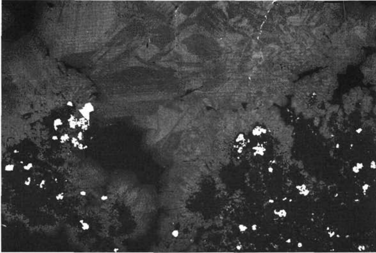
Abb. 13: Probe SO 26–198 D/6. Rhythmisch konzentrisch-schalige Schalenblende (dunkelgrau) geht randlich in größere Aggregate von Zinkblende (ebenfalls dunkelgrau, verschiedene Töne) über. Diese zeigt teilweise Ausbildung von Kristallflächen und weist geringe Unterschiede im Reflexionsvermögen auf. Dadurch läßt Zinkblende den Kornaufbau ihrer Aggregate, Verzwilligung, auch polysynthetische Lamellen und Zonarbau erkennen. Örtlich findet sich ein wenig Pyrit und Chalkopyrrotin (beide hellgrau, fast weiß). Natürliche Poren bzw. Hohlräume, wenig Gangart (schwarz). Anschliff, Ölimmersion, Vergr. 150 ×.
