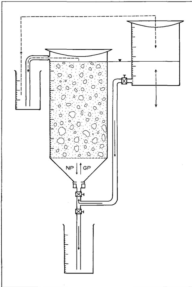
Abb. 4: Schema der Meßanordnung für die Bestimmung des trocken auffüllbaren ( $\approx$  Gesamtporosität GP) und frei entwässerbaren ( $\approx$  Nutzporosität NP) Porenraums bzw. durchflußwirksamen Hohlraumanteils von Sedimentproben.
