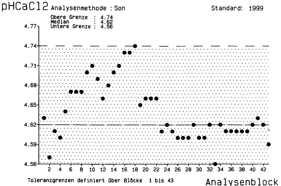
Abb. 3: Ergebnisse der pH-Wert-Bestimmungen des Projektstandards in 0,05 m CaCl<sub>2</sub>-Lösung.
