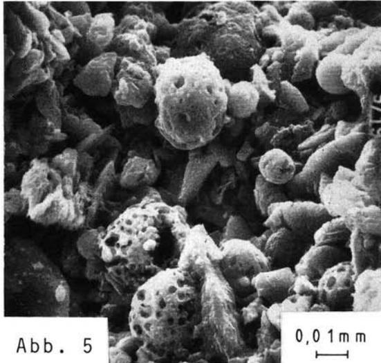
Abb. 5: In den Krustenbildungen finden sich neben Staub und Rußpartikeln auch kugelförmige Flugascheteilchen (Vergrößerung 1150 $\times$ ).
