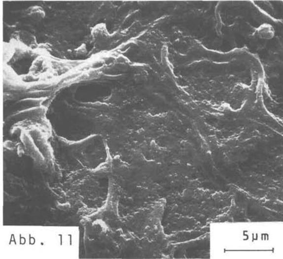
Abb. 11: Durch das Wachstum bestimmter Organismenstämmen (im Bild *Penicillium rugulosum* THOM) kommt es zu Ätzungen an der Oberfläche von Kalzitkristallen (Vergrößerung 1900 $\times$ ).
