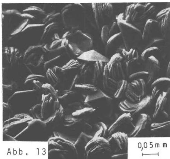
Abb. 13: Zwei unterschiedliche Kristallformen wurden von *Penicillium variable* auf Kalzitanschliffen erzeugt; bei den tetraederförmigen, bipyramidalen Kristallen dürfte es sich um Weddellit, bei den stapelförmigen um Whewellit handeln (Vergrößerung 270 $\times$ ).
