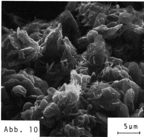
Abb. 10: 90 Jahre alte Abbauwand; auf der Innenseite der Verwitterungskrusten finden sich Grünalgen und Pilzhyphe (Vergrößerung 1800 $\times$ ).
