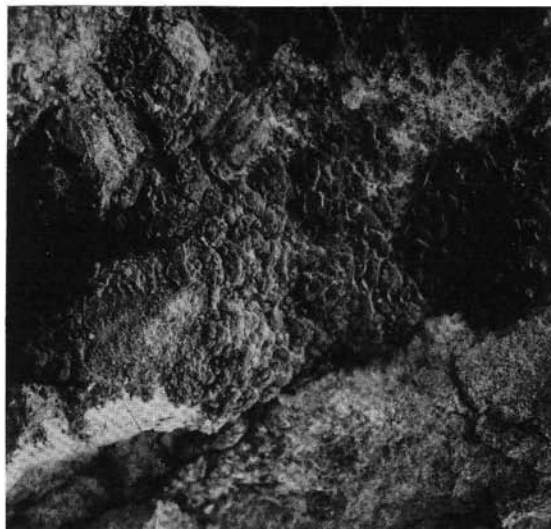
Abb. 7: 90 Jahre alte Abbauwand im Steinbruch St. Margarethen; an regengeschützten Stellen zeigen sich ähnliche, aber wesentlich dünnere und chemisch anders zusammengesetzte Krusten als am Stephansdom.
