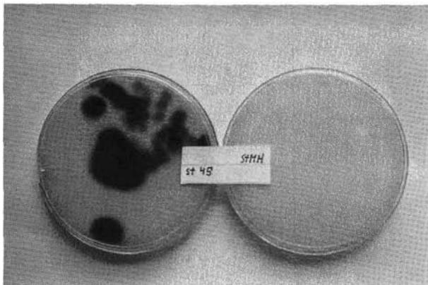
Abb. 14: Testplatten mit steriler Vergleichsplatte (rechts) und Agarplatte mit gemahlenem St. Margarether Kalksandstein; deutlich sind die durch Pilze hervorgerufenen Lösungshöfe zu erkennen.
