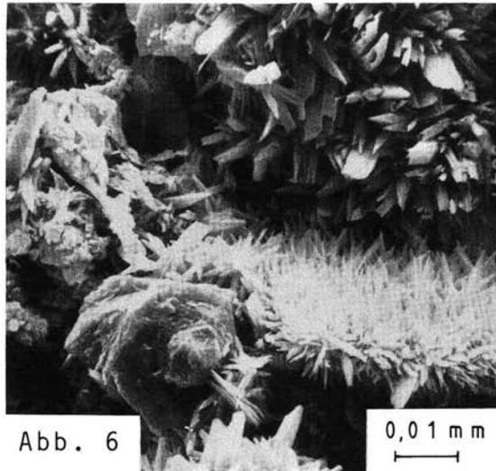
Abb. 6: Neugebildete idiomorphe Gipskristalle treten als Überzüge auf den Krustenoberflächen auf (Vergrößerung 950 $\times$ ).
