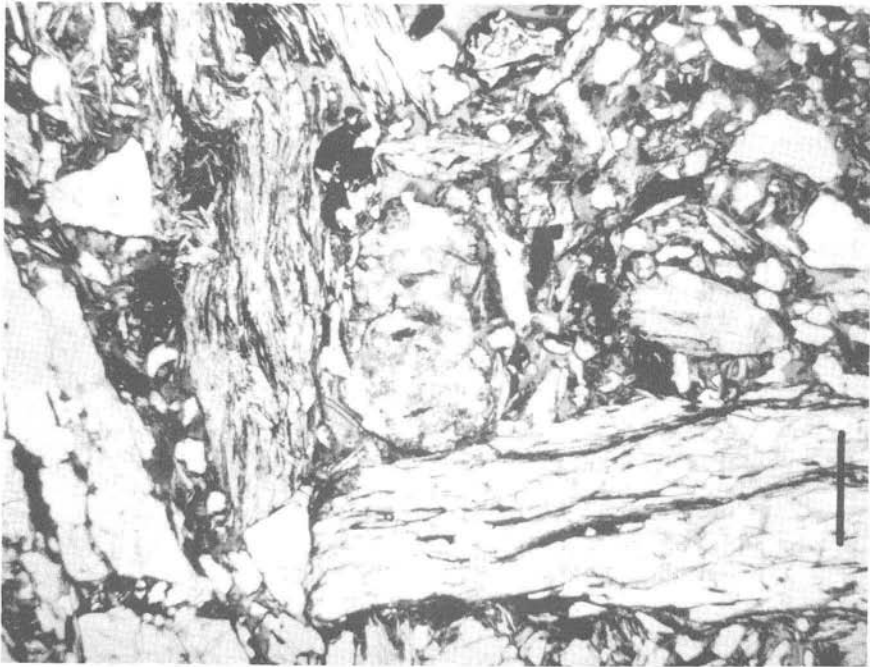
Abb. 10: Dünnschliffaufnahme der „Phyllitbreccie“, die ausschließlich aus Komponenten des unterlagernden Kristallins (mono- und polykrist. Quarze, detritische Glimmer und vor allem diverse Phyllit- und Glimmerschieferbruchstücke) zusammengesetzt ist. // Nicols, Balkenlänge 0.5 mm.
