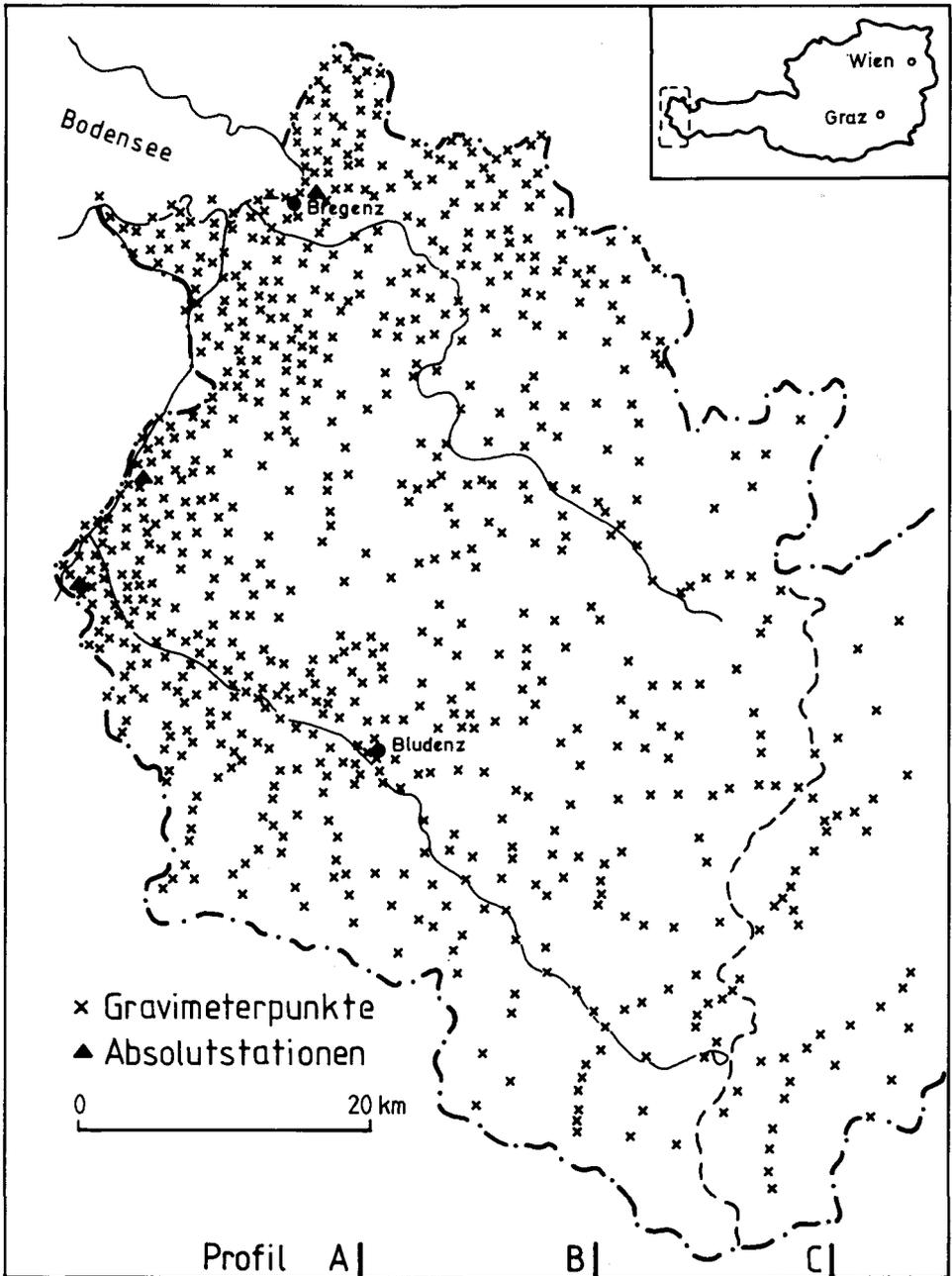
Abb. 1: Verteilung der Gravimeterpunkte für die Übersichtsvermessung und Lage der Absolutstationen.
