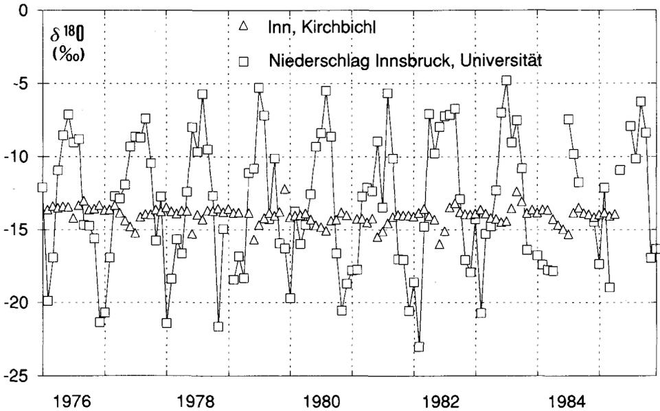
Abb. 7: Beispiel einer Zehn-Jahres-Meßreihe des  $^{18}\text{O}$ -Gehaltes im Niederschlag (Innsbruck, Universität, gewichtete Monatsmittel) und im Oberflächenwasser (Inn, Kirchbichl, monatliche Stichproben).
