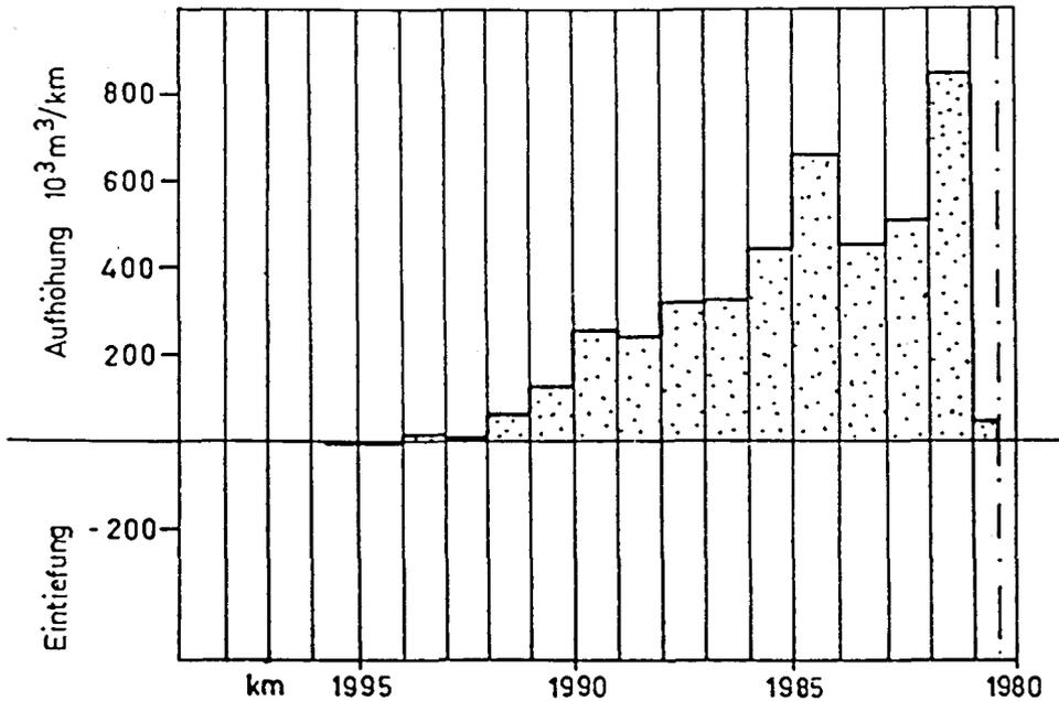
Abb. 2: Stromsohlenänderung oberhalb Kraftwerk Altenwörth (Daten: Wasserstraßendi-
