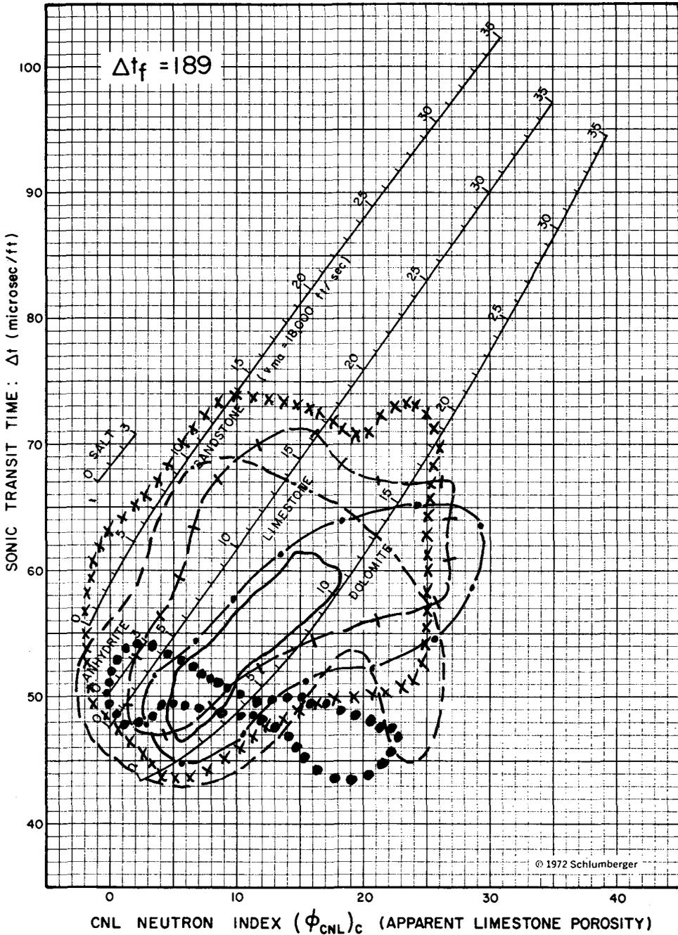
Abb. 7: Crossplot „Sonic vs. Neutron“ für die Obertriasschichtglieder. Der Crossplot beruht auf der Schlumberger-Chart (SCHLUMBERGER 1986) zur Porositätsbestimmung und Lithologiedefinition. Erläuterung der Signatur s. Abb. 8.
