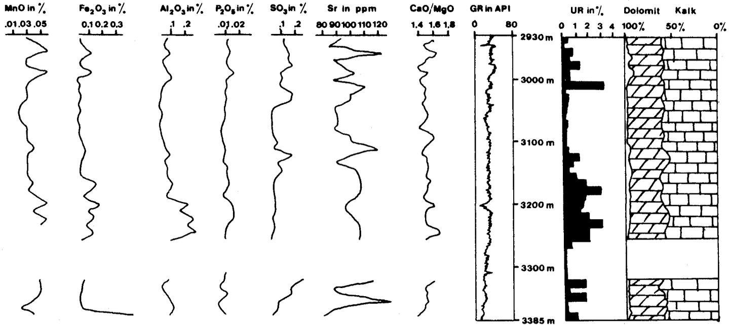
Abb. 12: Basale Hauptdolomitfolge in der Bohrung SCHÖNKIRCHEN-TIEF 32 (2930-3385 m GR-Log). Die GR-Aktivität korreliert mit geochemischen Analysen des unlöslichen Rückstandes. Der unlösliche Rückstand (UR) ist in Prozent (Skala 0-5%) angegeben. Der Kalkanteil (Mauersteinsignatur) und der Dolomitanteil (schräge Mauersteinsignatur) sind rechts dargestellt.
