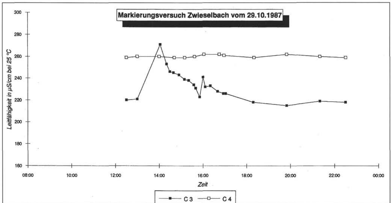
Abb. 5. Tracerdurchgang an der Quelle C3 vom 29. Oktober 1987 im Vergleich zur Ganglinie der gemessenen elektrischen Leitfähigkeiten an der Quelle C4.
