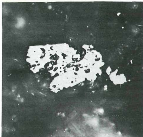
Abb. 6: Erzmikroskopische Aufnahme (Öl) eines Ilmenitkornes, das Löcherigkeit und Andeutungen von Kristallflächen zeigt, aus dunkler Lage des Tuffites vom Rechberg bei Frohnleiten, Steiermark. Größter Durchmesser des Ilmenitkornes 0,05 mm.
