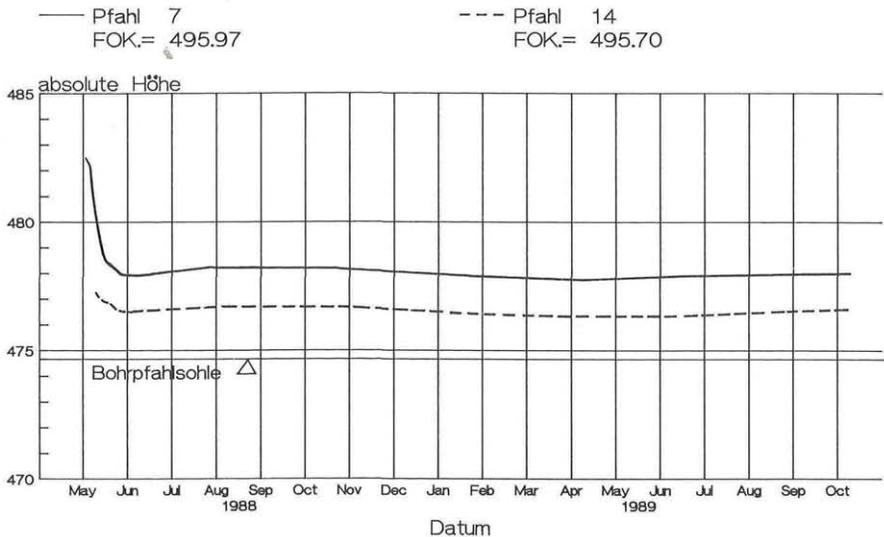
Abb. 2: Diagrammdarstellung über Wasserstandsbeobachtungen.
