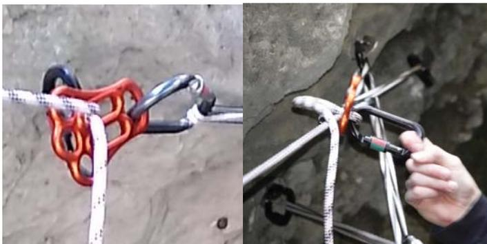
**Bild 4: Riggingplatte (Kong) als Ersatz des Halbmaster-Knotens**
