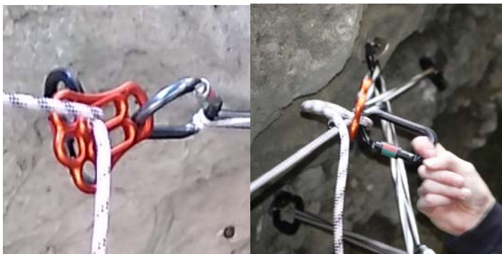
Bild 4: Riggingplatte (Kong) als Ersatz des Halbmaster-Knotens
