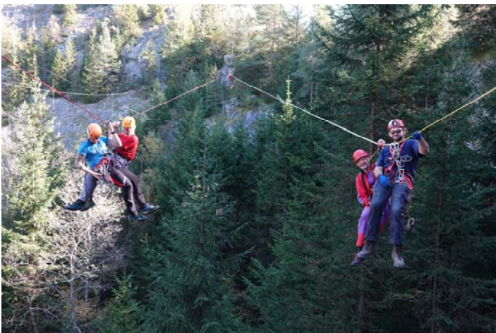
Bild 1: Dyneema- und Statikseilbahnen im direkten Vergleich (links Dyneemaseil; rechts Statikseil)
