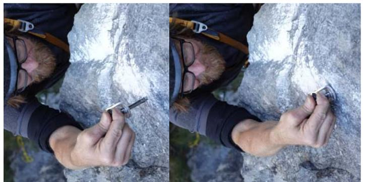
**Bild 2: Beim Setzen eines Petzl Pulse-Ankers**
