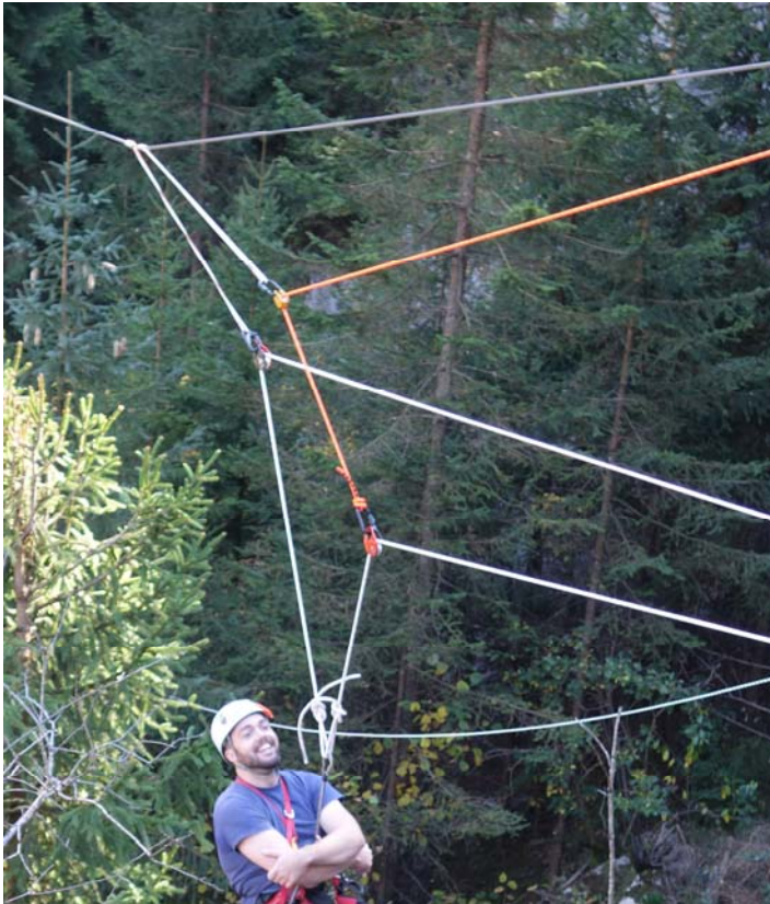
Bild 3: Seilaufbau für einen vertikalen Aufzug mit nachfolgender horizontaler Bergstrecke
