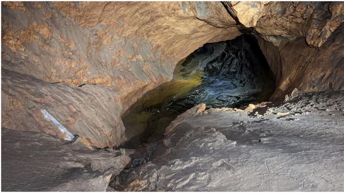
**Bild 2:** Der tiefe Wasserstand des *Krenn-Siphons*. Links an der Wand ist das 70 cm lange Alu-Profil zu sehen (enthält den Logger).
