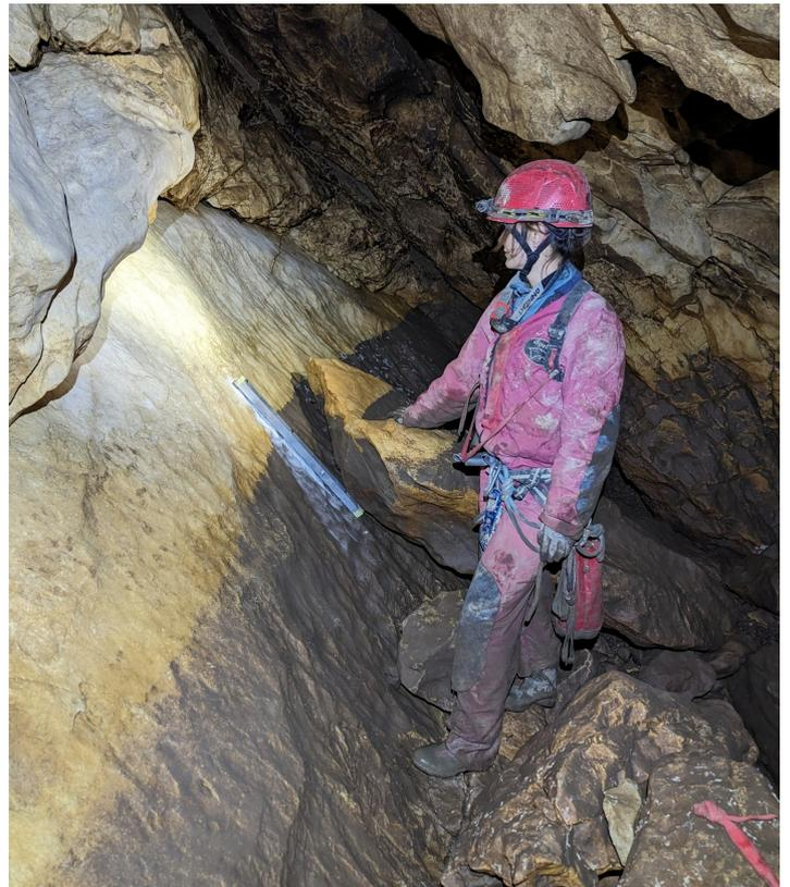
**Bild 1:** Der „normale“ Niederwasserstand des *Tormannsiphons* ist an der Lehm-Marke erkennbar. Links an der Wand ist das 70 cm lange Alu-Profil zu sehen, in dem sich der Logger befindet.
