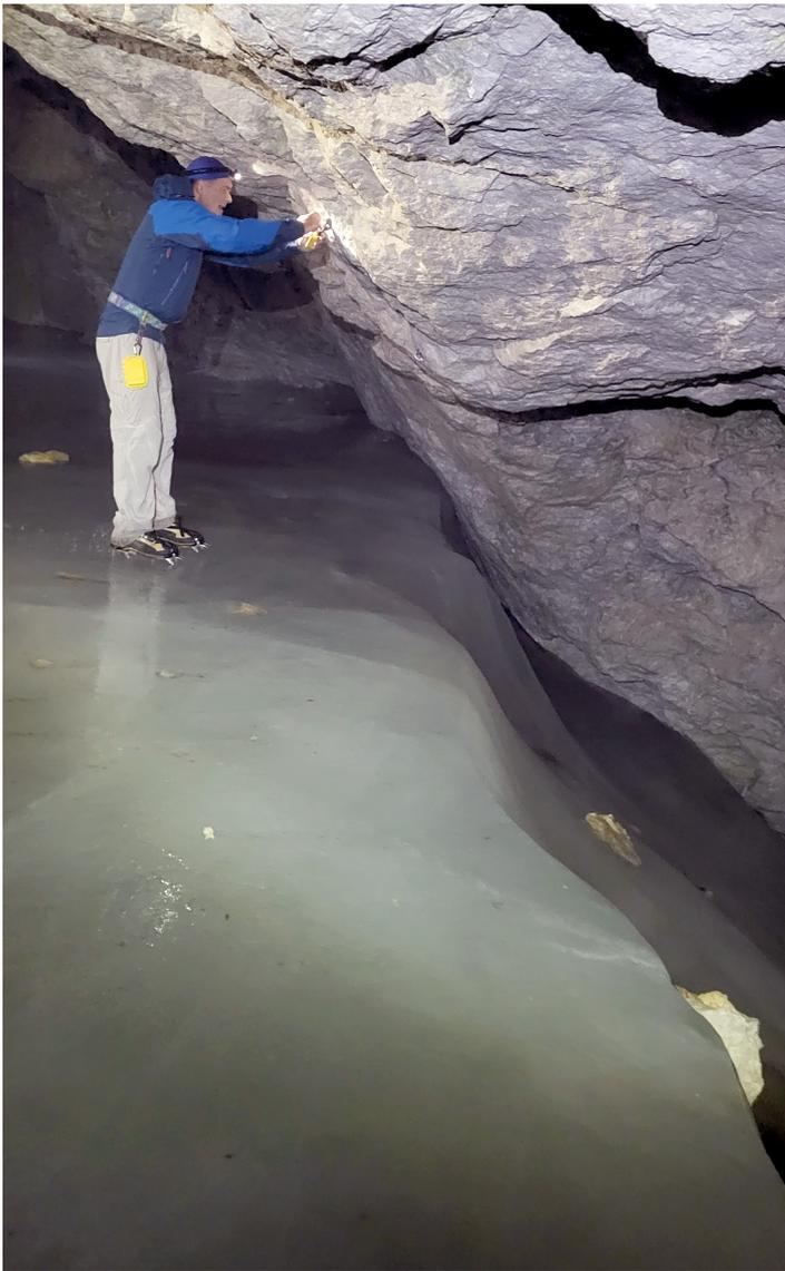
**Bild 6: Datenloggerwechsel beim Eisbläser**
