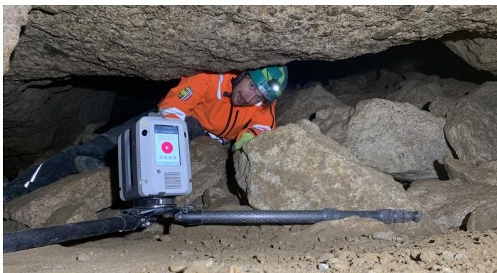
Bild 8: Um die niedrigen Abschnitte gut aufnehmen zu können, musste der Scanner oft umgestellt werden. Aber nicht nur die niedrigen Teile forderten die Vermesser intensiv heraus, sondern auch jene mit großem Niveau-Unterschied.
