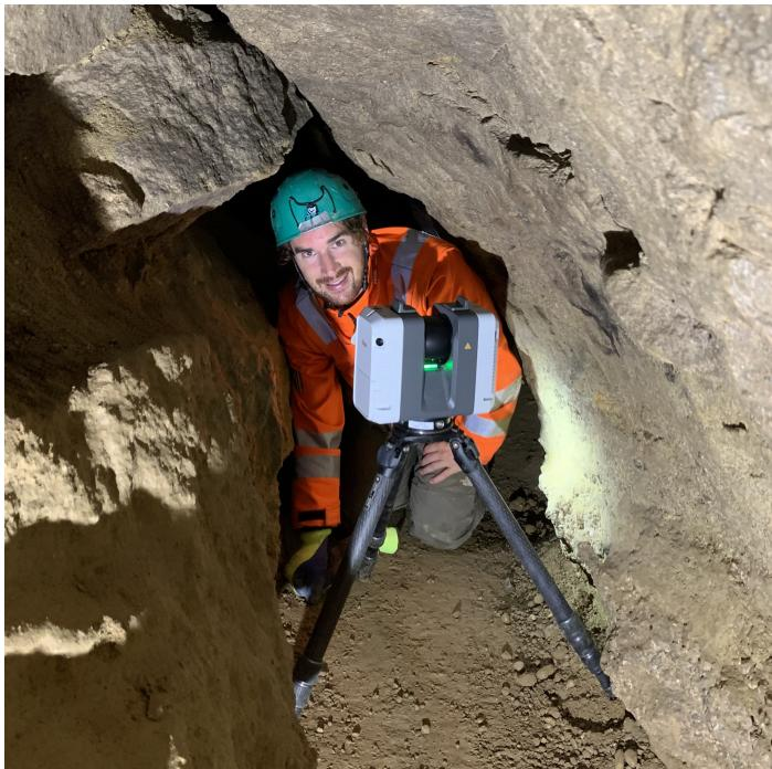
Bild 7: Die 3D-Vermessung der Steyregger Höhle wurde von der Vermessungsabteilung des Landes mit viel Einsatz und Engagement in neun Tagen abgewickelt.
