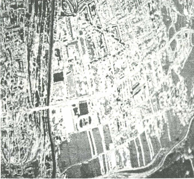
Abb. 7. Ausschnitt aus einem Thermalbild der Stadt Innsbruck. Der Gleisbereich des Bahnhofes (links) und das Dach des Eisstadions (unteres Drittel links von der Mitte) markieren die wärmsten Flächen ( > 35\text{ C} ), die grauen Felder unten rechts die kältesten Objekte ( \sim 21\text{C} ). Norden ist oben. Nach einem Farbdiapositiv.
