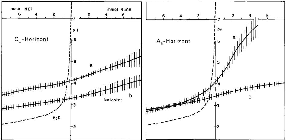
Abb.1 Pufferkurven aus den  $O_L$ - und den  $A_h$ -Horizonten belasteter und unbelasteter Böden (Durchschnittskurven aus 10 - 11 Bestimmungen; die Breite der schraffierten Fläche gibt die Standardabweichungen der Einzelwerte an). Näheres s.Text.
