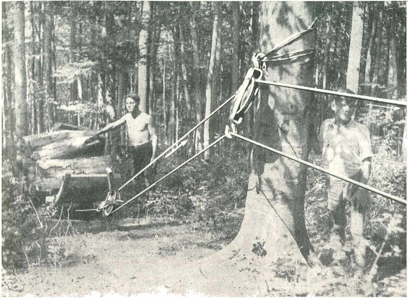
Abb. 13: Aufseilen von Schichtholz auf gekrümmter Gleitbahn. Anordnung der Seilführung bei 30 cm Fördergeschwindigkeit. Der obere Seilstrang bewegt sich zur Maschine (→), der untere ist ohne Bewegung. Kurz vor dem Passieren des Winkelpunktes durch den Schlitten werden die Seile von der Seitenablenkscheibe abgenommen.
