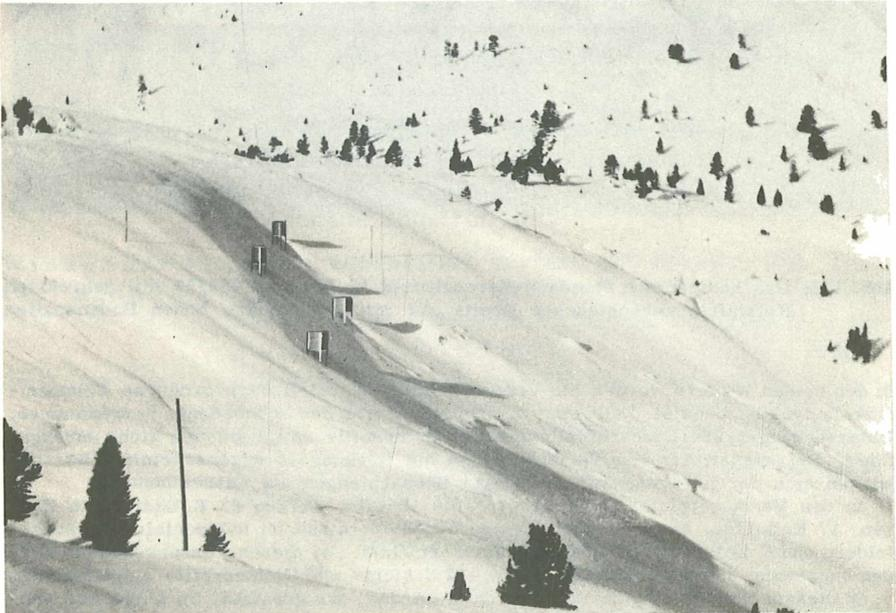
Abb. 175: Der Kolktafel-Versuchshang im Winter 1951/52 mit vier gekreuzten Kolktafeln im südlichen Hangbereich. In den Wintern 1950/51 und 1953/54 wurden auch im rechten Teil des Hanges Versuchsbauten errichtet. Blickrichtung NW, Hauptwindrichtung von links nach rechts (Föhn)
