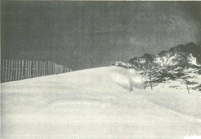
**Abb. 160:** Ablagerung hinter Schneezaun (Höhe 4 m, Füllung 60 % in versetzter Anordnung) schiebt sich gegen Lee vor (Versuchsverbauung Paida)
