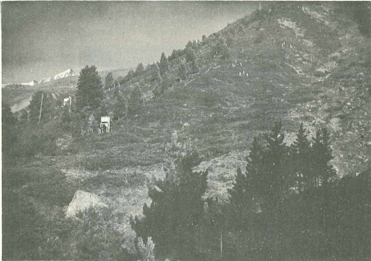
Abb. 8: Der Südwest - Einhang der "Blaikenrinne", diagonal im Bild verlaufend, mit den einzelnen verpflockten Meßstandorten. Die Holzkästchen sind als Meßkabel-Verteiler eingerichtet.
