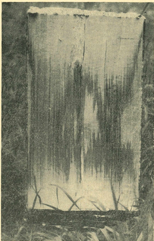
Abb. 2 Holzauflockerung durch typischen Weißfäulepilz ( Trametes versicolor )
