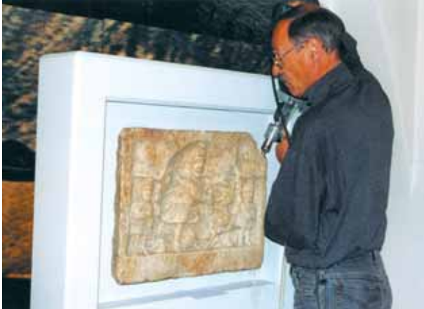
Marmorspezialist Harald W. Müller bei der Probenentnahme am Mithrasrelief in Tulln. Das ca. 1 cm dicke Loch wird nach der Bohrung wieder verschlossen
