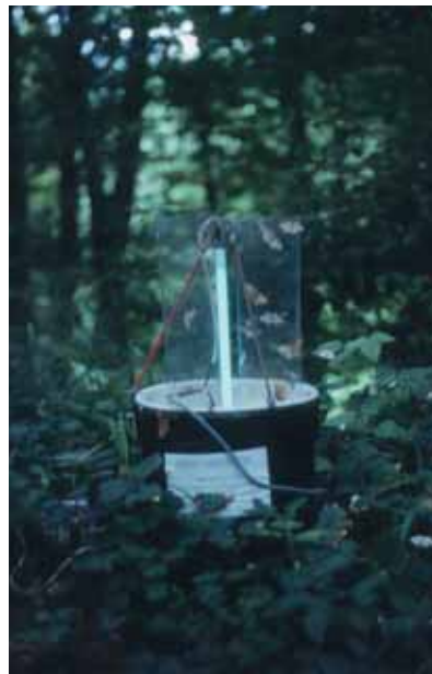
Automatische Lebendlichtfallen erweisen sich mit bis zu 1200 angelockten Faltern in einer Nacht vor allem im Hochgebirge als effektive Methode
