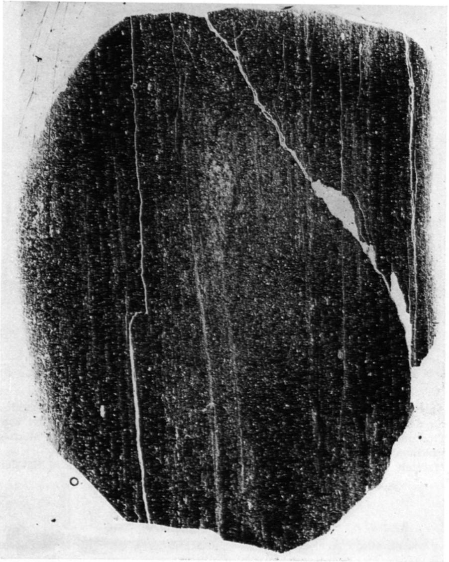
**Abbildung 25:** Dünnschliff durch einen aquitanen Schiefertton der Krafthausbaugrube von St. Pantaleon. Die Schichtflächen werden durch die rhythmische Streifung abgebildet.
