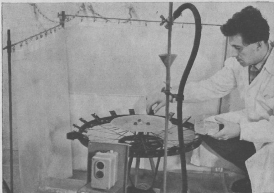
Gerät zur Bestimmung der Haftfestigkeit von Spritzbelägen verschiedener Schädlingsbekämpfungsmittel im Pflanzenschutzlaboratorium (Haag).
