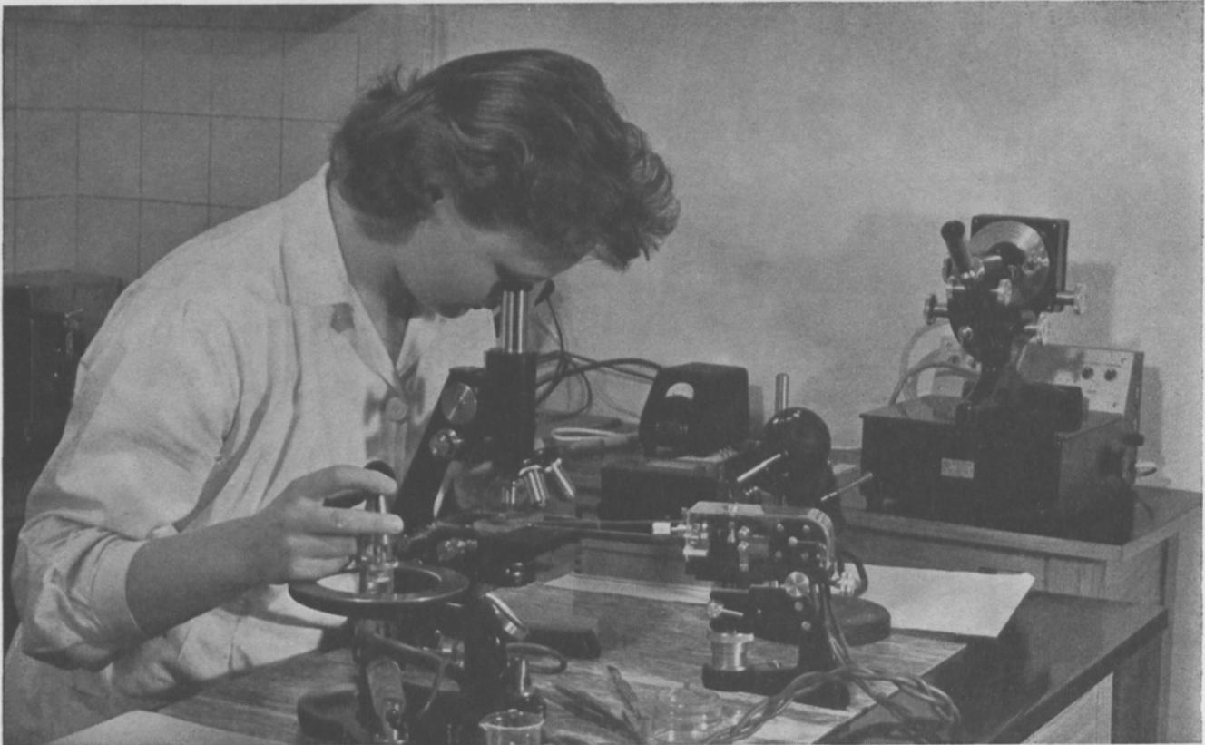
Ein pneumatischer Mikromanipulator gestattet mikrochirurgische Eingriffe an einzelnen Zellen. Im Hintergrund die „Mikroschmiede“ zur Herstellung der feinen Arbeitsgeräte.
