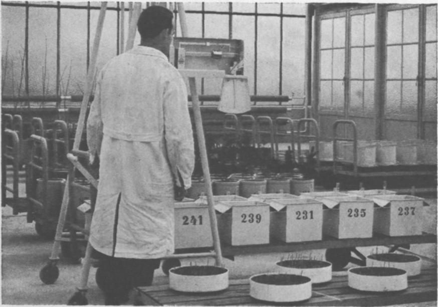
In der Gefäßversuchsanlage werden mit einer fahrbaren Waage täglich die einzelnen Gefäße gehoben und gewogen und die verdunsteten Wassermengen ergänzt.
