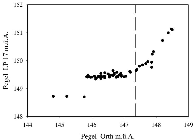
Abb. 5: Pegelstände bei LP 17 (oberhalb Gänsaufentraverse) entsprechend dem Wasserstand der Donau von 1. Feber bis 31. Juli 1999. Strichlierte Linie markiert Beginn der Anbindung (RECKENDORFER & HEIN 2000).
