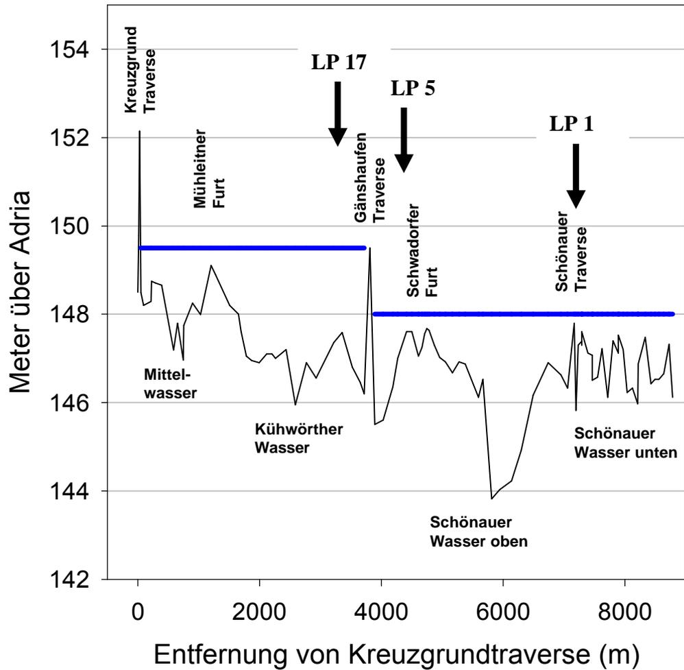
Abb. 2: Längsschnitt durch den Hauptgewässerzug. Blaue Linie – häufigster Pegelstand in den Becken. Pfeile markieren Standort der Lattenpegel (LP).
