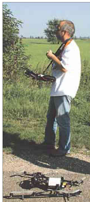
Gesteuert wird das Flugobjekt wie ein Modellflugzeug, ein Monitor zeigt die Perspektive der Kamera.
