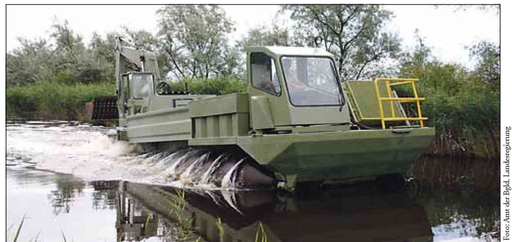
Seit fast 20 Jahren ist mit dem „Amphicut“ ein für den Neusiedler See taugliches Gerät zur Instandhaltung und Errichtung von Schilfkanälen im Einsatz.
